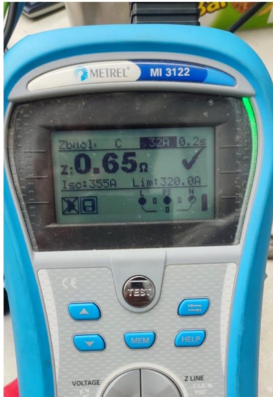
Proyecto / ALQUILA TU BODEGA MONTAJE INSTALACIÓN INTERIOR GALPÓN – PRUEBA EN DIFERENCIALES
