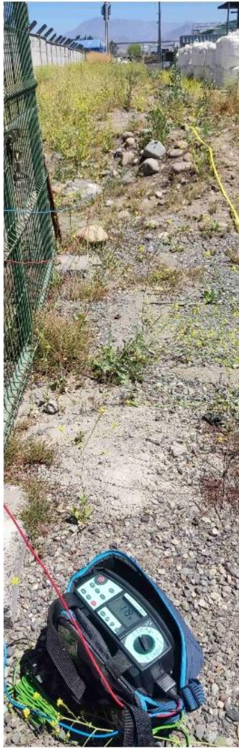
Proyecto / QUIMETAL - MEDICIÓN DE RESISTENCIA MALLA MEDIA TENSION TRANSFORMADOR 4
