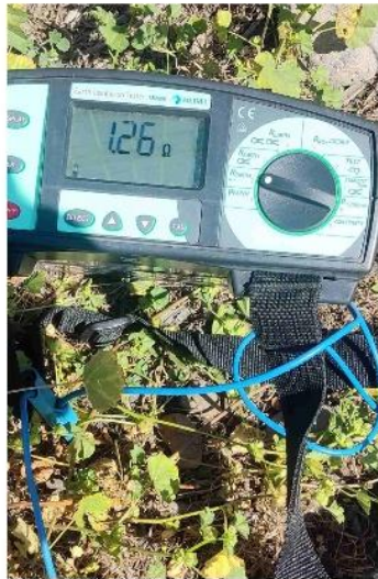
Proyecto / QUIMETAL - MEDICIÓN DE RESISTENCIA MALLA MEDIA TENSIÓN TRANSFORMADOR 5
